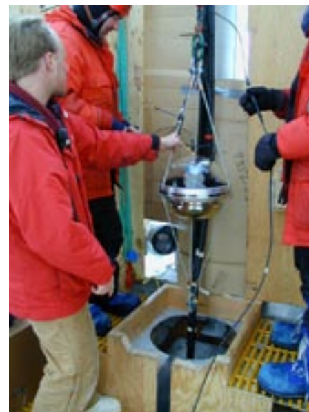
Bild 4: En optisk modul kontrolleras innan den sänks ned i hålet.
